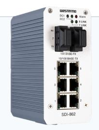
Der SDI-862 ist ein einfacher und kosteneffizienter unmanaged Glasfaser Switch für den Einsatz in einer Vielzahl von Anwendungen der Fabrik- und Gebäudeautomation. Es sind zwei Modelle erhältlich - Der SC2 zur Verwendung mit 2 km Multi-Mode-Glasfasern und der SC30 für Single-Mode-Anwendungen bis zu 30 km. Ein Highspeed-Switch-Core gewährleistet volle Geschwindigkeit an allen Ports und Transparenz für alle Ethernet-Protokolle.
