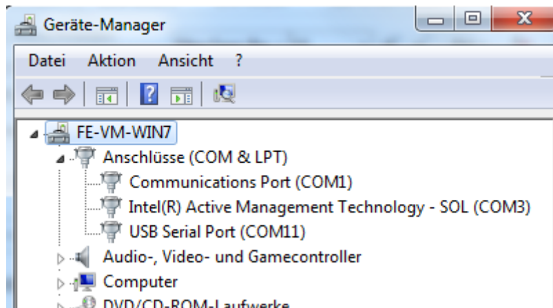
Windows-Geräte-Manager mit COM-Anschlüssen
